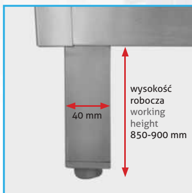
Noga z profilu kwadratowego chromowo-niklowego 1.4301, przekrój 40x40 mm, regulowana -10/+60 mm. Możliwość zwiększenia wysokości z 850 do 900 mm The leg is made from square profile 40x40 mm of stainless steel 1.4301, -10/+60 mm adjustable. The possibility of raising the height from 850 to 900 mm.
