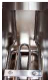
bez pokrywy ochronnej grzałek i kapilar
